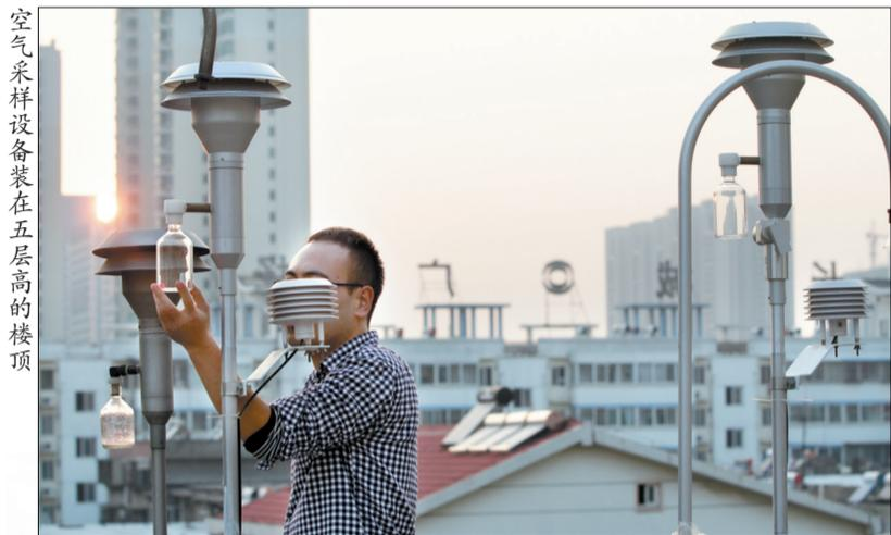
空气采样设备装在五层高的楼顶
