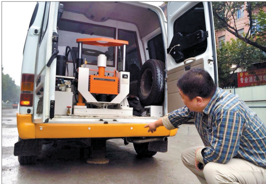
这台新型检测设备就是靠尾部底盘下方的重力锤来检测道路承载能力的
