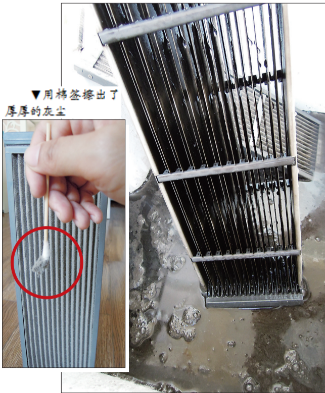
▲清洗静电除尘器的水黑得像墨汁一样
