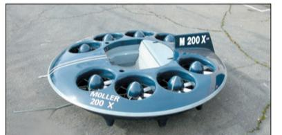
M200 Neuera利用8个电控风扇让其与地面之间保持3米左右的距离,并且无论是草地还是海面,M200 Neuera都能够成功悬浮。而在贴地行驶时,其速度与普通汽车无异,最快能达到160千米/小时,在海面上速度能够达到321千米/小时,而在7000米高空,最快速度能够达到643千米/小时,是目前最有希望量产的垂直起降飞行器。
