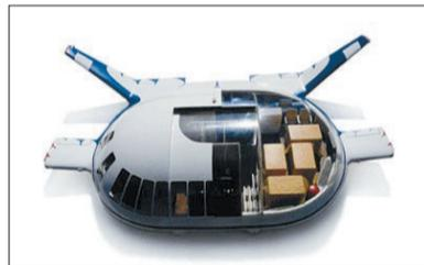
EKIP的意思是Ekologiya i Progres,意思为“生态与进步”。该飞行器由俄罗斯科学家列夫·舒金(Lev Shukin)和亚历山大·索伯科(Alexander Sobko)共同研发。EKIP的外观看起来就像甲壳虫。而实际证明,它飞起来绝对没有问题,根据设计,它最多可以承载300吨货物或者100名乘客以及100吨货物,每小时飞行速度可达500千米~700千米,飞行高度为8千米~13千米,可借助气垫以每小时160千米的速度靠近地面或水面飞行。
