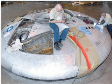
该型飞机由加拿大Avro飞行制造公司设计,原计划服役于美国陆军。这个项目于1958年启动,目的是借助柯恩达效应,用“涡轮风扇”将两名美国大兵带起。它最大的特点就是能够垂直起降,这在当时可是一个稀罕技术,而在升空之后,VZ-9 Avrocar就可以像飞碟一样飞行。
