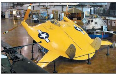
V-173是F5U飞行薄饼的原型机,由Charles H. Zimmerman设计,机身的特点就是没有机身,两个螺旋桨的驱动可以将整个圆盘带起。由于设计特殊,飞机具有惊人的短距起降能力,非常适合航母起降。由于飞行员只需要控制两个螺旋桨,因此操控性能非常好。正是在V-173的鼓舞下,美军造出了两架XF5U-1原型机。不过由于在1948年,美军开始放弃螺旋桨驱动的战斗机,“飞饼”飞机也被随之取消。
