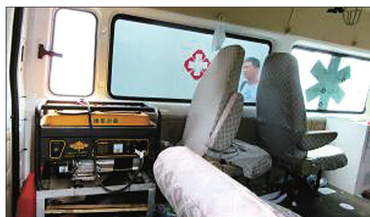
急救车经过改装，车内安装了发电机 (网络图片)
