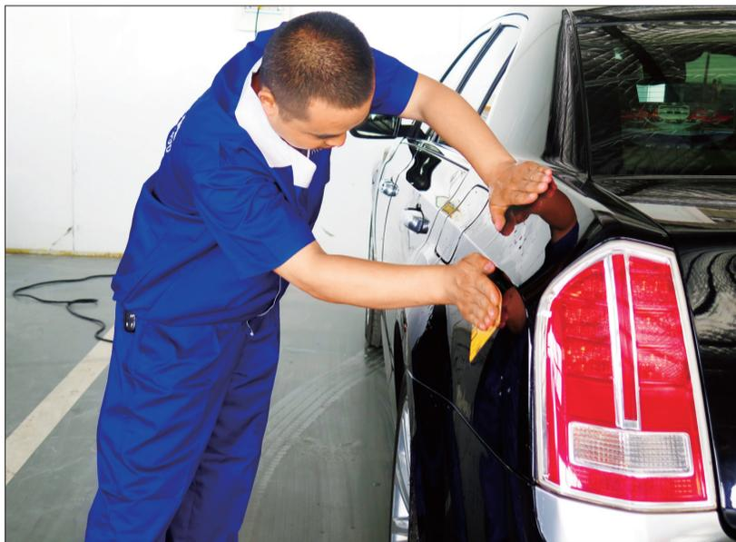
维修人员正在用2000号水砂纸打磨车辆伤痕处
