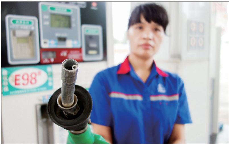
加油站工作人员展示加油枪,大的管子负责加油,小的管子负责从油箱里吸油气
