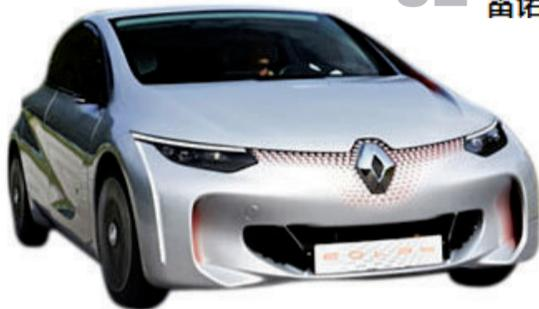
在巴黎车展上,雷诺展示了其在超低油耗汽车探索方面的最新成果——EOLAB混合动力原型车。在欧洲油耗及排放评定标准(NEDC)的测试中,EOLAB的百公里油耗仅为1升,百公里二氧化碳排放量只有22克。雷诺全新自主研发的Z.E. Hybrid系统,由一台1.0升三缸汽油发动机与一台电动机组成,在最高时速120公里、行驶距离在60公里以内时,可完全实现零排放。该车运用了约100项全新技术,这些技术都将陆续应用到雷诺的其他车型中。
