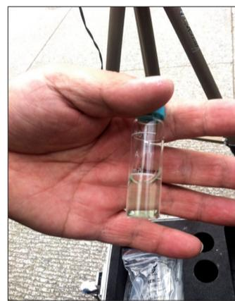
第二次的实验试剂,颜色已经淡了很多,说明甲醛含量变低了
