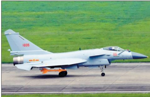
装备“太行”发动机进行试飞的歼-10B战机
