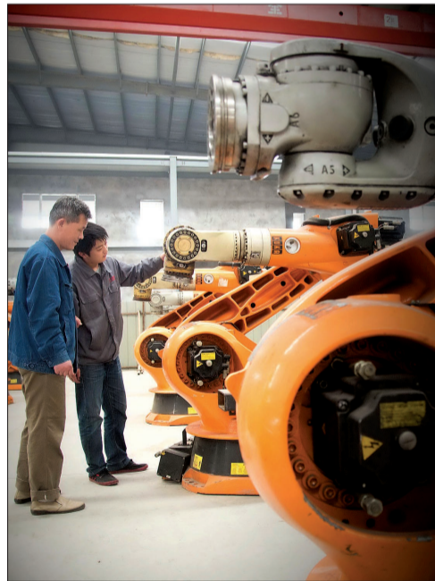
工作人员在调试焊接机器人
