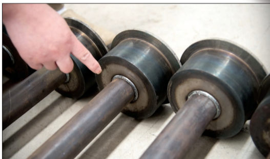
焊接机器人焊接的焊接件焊缝光滑、平整,质量上乘
