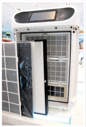
有6层过滤网的空气净化器
