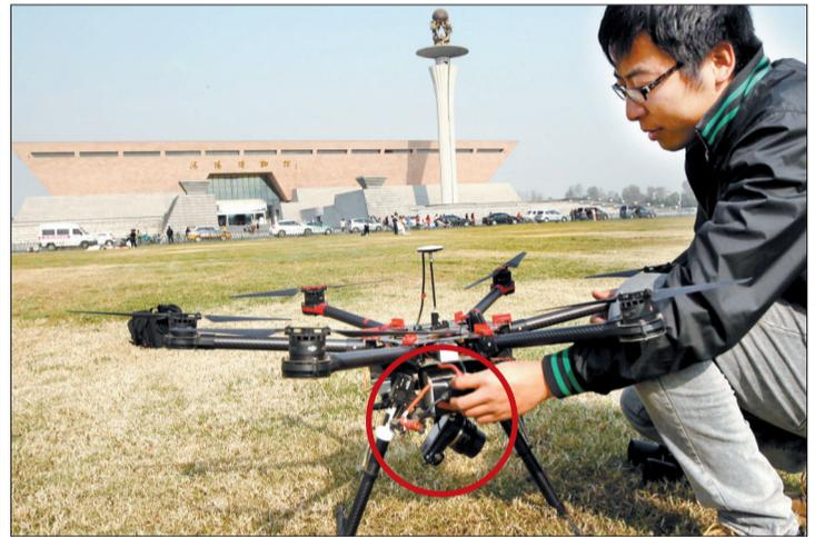
瞧,航拍模型飞机下挂着拍摄设备,对洛阳博物馆进行多角度拍摄,技术人员将根据此实现整体建筑的高清立体成像。
