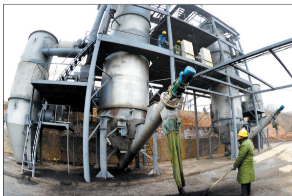
大型秸秆炭化炉
