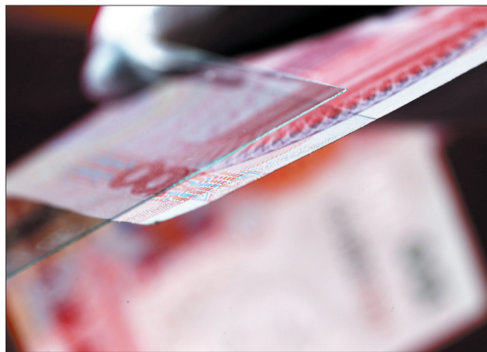
0.25毫米浮法玻璃的厚度与百元纸钞不相上下
