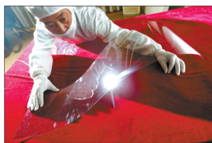
0.25毫米浮法玻璃具有良好的韧性
