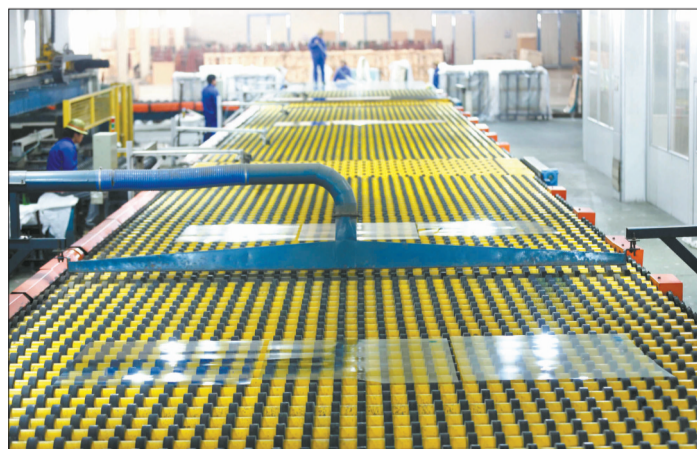
0.25毫米浮法玻璃生产线
