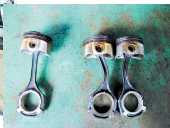
◀ 不同车的密封圈数量不同 ▼ 正常的活塞连杆(左)和被水打弯的活塞连杆(右)
