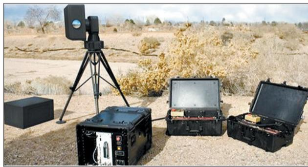
波音公司研制的紧凑型激光武器系统由四个易于组装的部分构成
