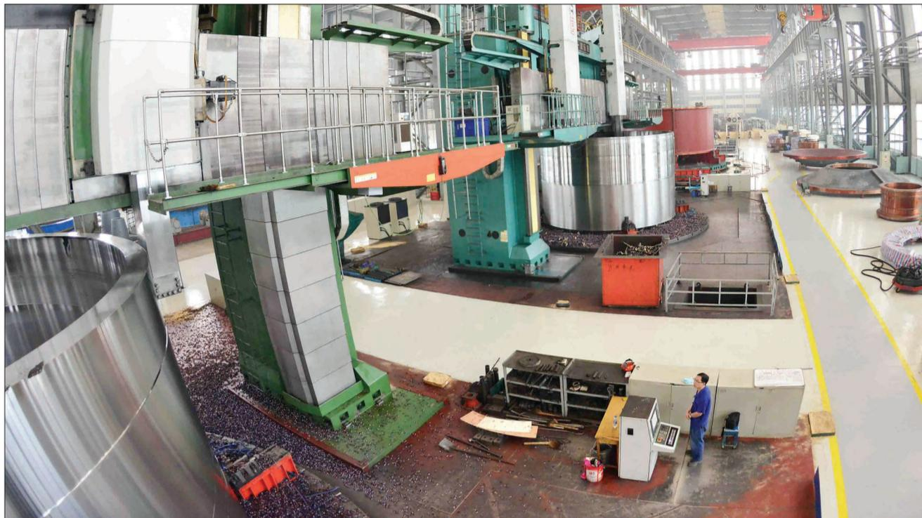
我市立足现有基础,通过谋划实施一批重大项目、加快技术改造、加强技术创新平台建设、加强要素保障,精心培育了一批具有规模优势、核心竞争力和抗风险能力的大企业和企业集团。图为中信重工公司的国内最先进的16米数控车床群正在加工一批即将出口伊朗的大型加氢反应器装置筒体。该型筒体直径6.9米,高4米,重量达到230吨,为国内生产的最大的石油化工领域加氢反应器装置筒体。
