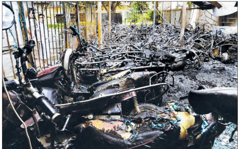
郑州某小区电动车充电引发的火灾现场 (网络图片)
