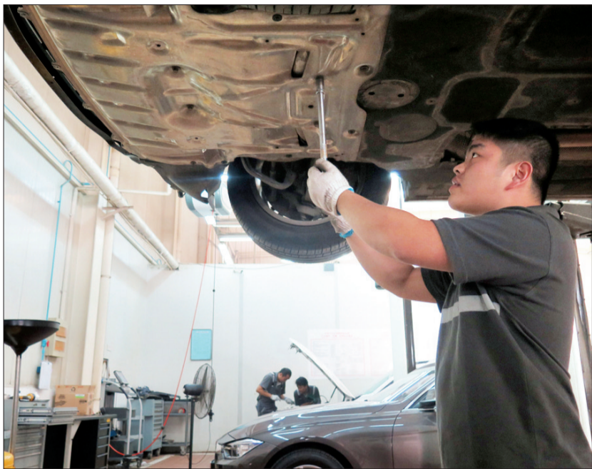
4S店工作人员正在为车辆安装发动机护板
