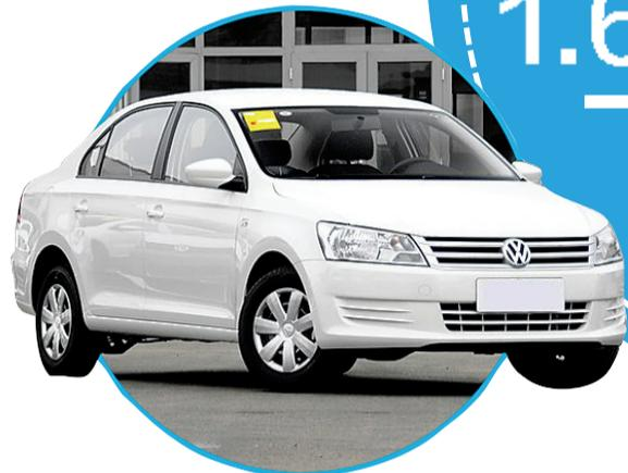
在外观上,桑塔纳·尚纳依然沿用了大众品牌家族式的“脸谱”,采用大众标志性的横置进气格栅,在视觉上拉宽了车辆前脸,让整车看上去更加大气、稳重。车身侧面造型较为硬朗,车身尺寸长4473毫米、宽1706毫米、高1469毫米,轴距为2603毫米。在内饰方面,这款车为标准的大众风格,总体设计中规中矩,中控台多处采用镀铬设计,增加了内饰的
