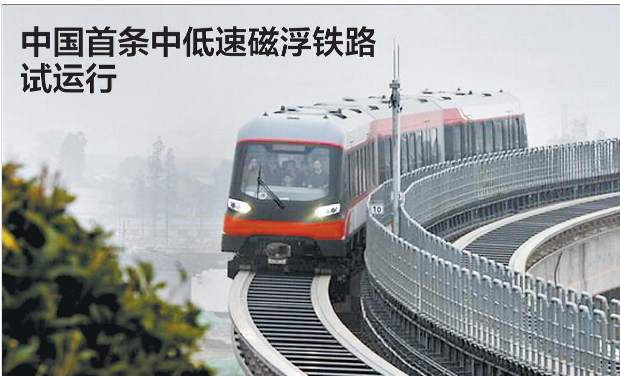
12月26日,中国首条拥有自主知识产权的中低速磁浮铁路——湖南长沙中低速磁浮快线试运行。这条磁浮快线连接长沙火车南站和黄花机场,全长18.55公里,全程线路高架敷设。列车按照3节编组设计,总长48米,最大载客量为363人,设计最高速度为每小时100公里。此次试运行,意味着长沙磁浮快线已经初验合格,接下来将按照试运营标准进行系统试运转、安全测试等非载客运行。图为12月22日,记者拍摄的调试中的磁浮列车。(人民网)
