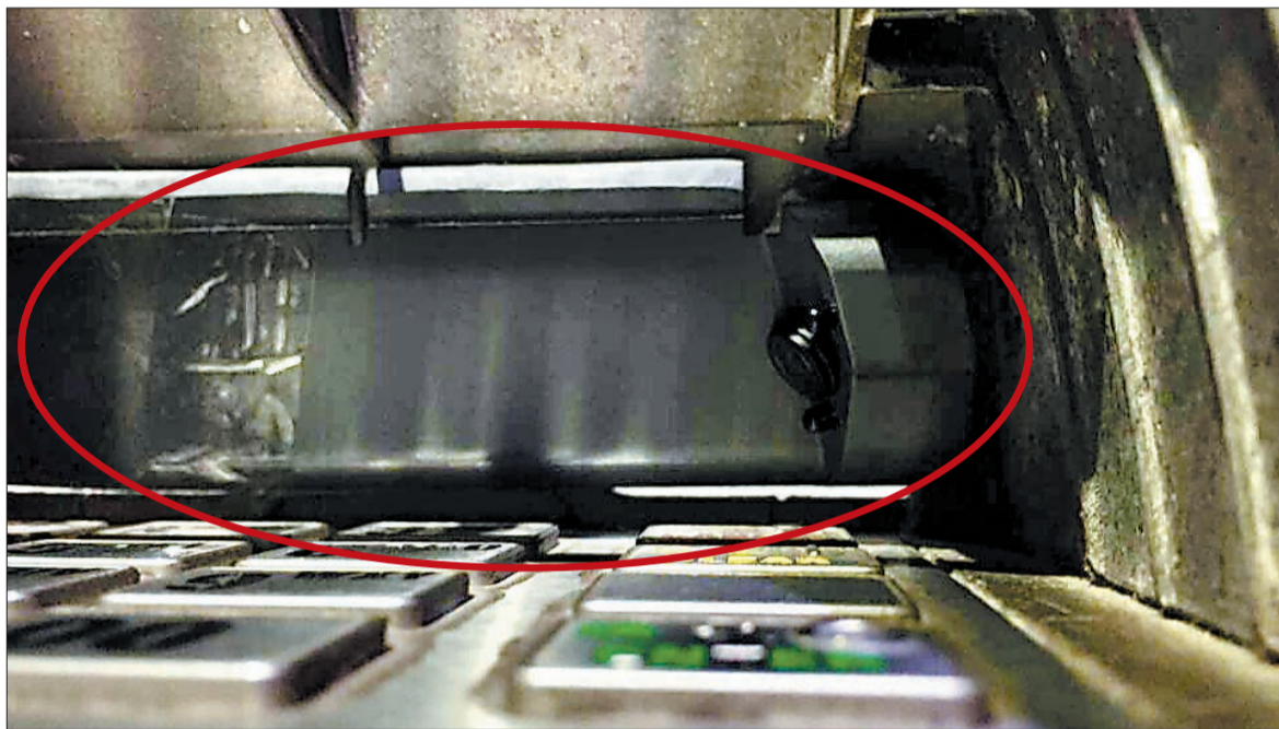
防窥盖内,摄像头和附属设备被胶带固定
