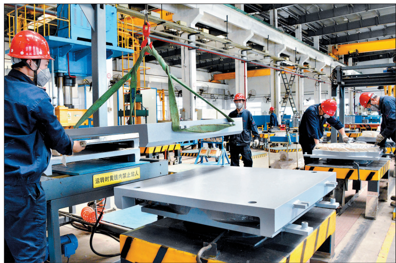
在中船重工第七二五研究所双瑞特种装备有限公司,桥梁支座部件正加紧生产 记者 鲁博摄
