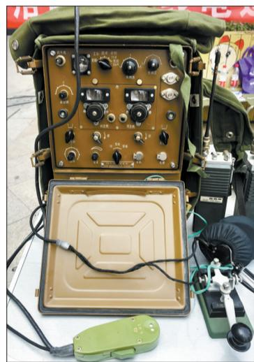
郝先生说，硅二瓦短波电台在139型收讯机的基础上，增加了无线电信号的发射功能，也就是说，它是一台能够收发无线电信号的短波电台。
