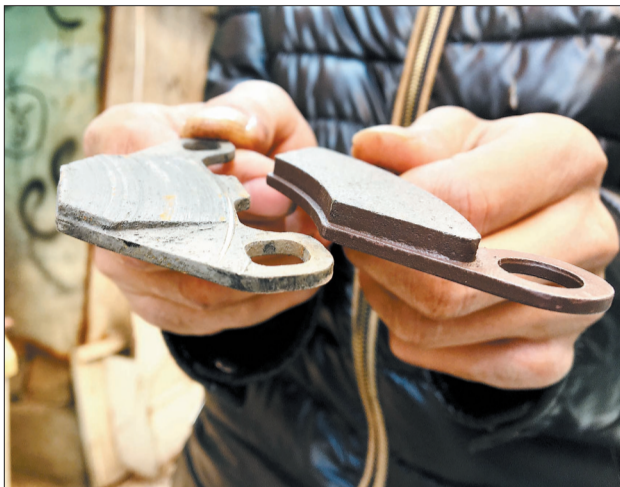
新刹车片(右)和磨损严重的刹车片对比
