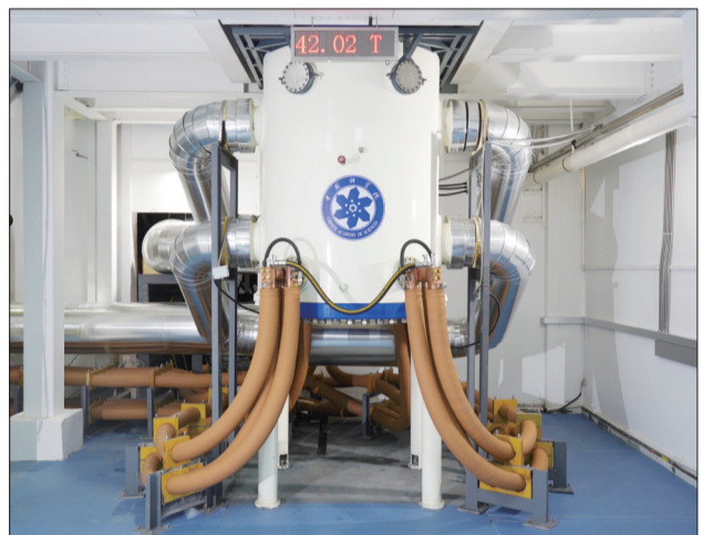
中国科学院合肥物质科学研究院强磁场科学中心内的水冷磁体 (新华社发)
